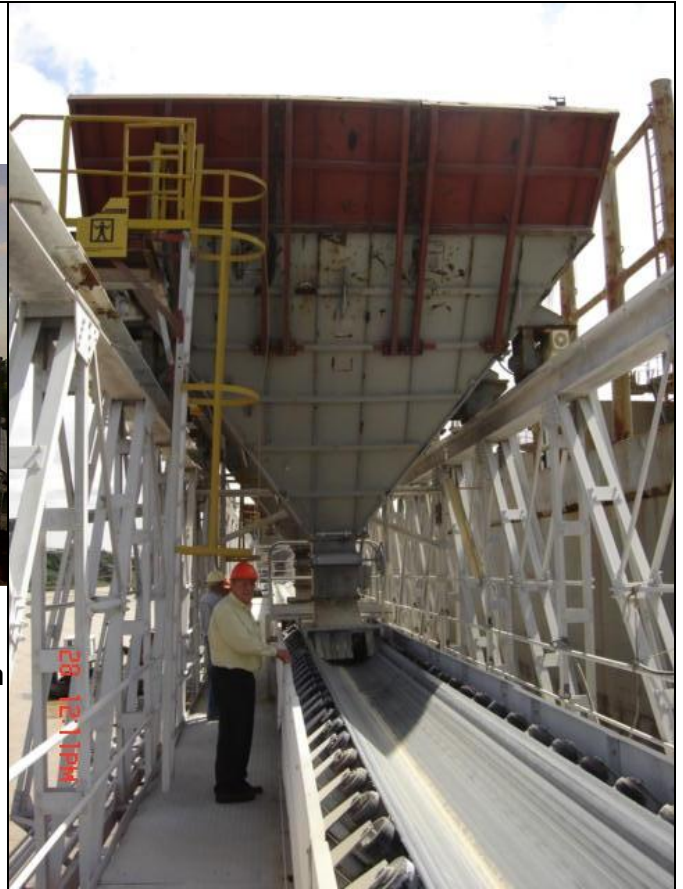
Vista de una instalación de descarga similar a la que prevé Pier Doce, compuesta por una cinta transportadora y tolva móvil, emplazada en el Río Paraná
